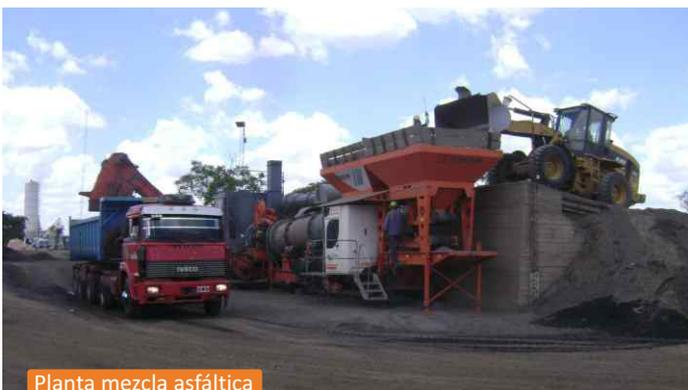
Planta mezcla asfáltica
